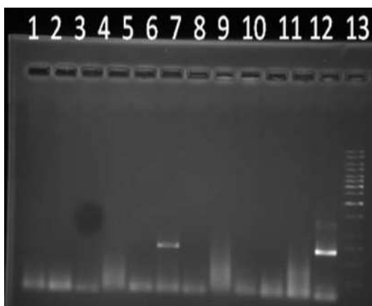
عکس ۱- ژل الکتروفورزس تعدادی از محصولات PCR، خط ۱ کنترل منفی، خط ۱۳ سایز مارکر، خط‌های ۲-۵ و ۱۱-۷ منفی، خط‌های ۶ و ۱۲ مثبت
