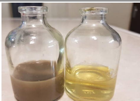
شکل ۲- سنتز سبز نانوذرات اکسید روی (A): محلول نیترات روی، (B): نانوذرات اکسید روی سنتز شده.
