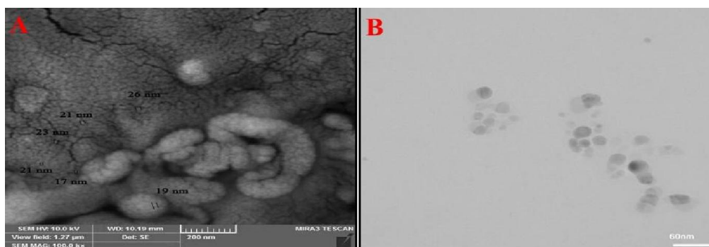
شکل ۱- بررسی خصوصیات به دست آمده از نانوذرات سلنیوم تصاویر SEM (A) و TEM (B). همان‌طور که در تصاویر دیده می‌شود، اندازه نانوذرات کمتر از ۵۰ نانومتر بود و شکل آن‌ها تقریباً کروی می‌باشد.
