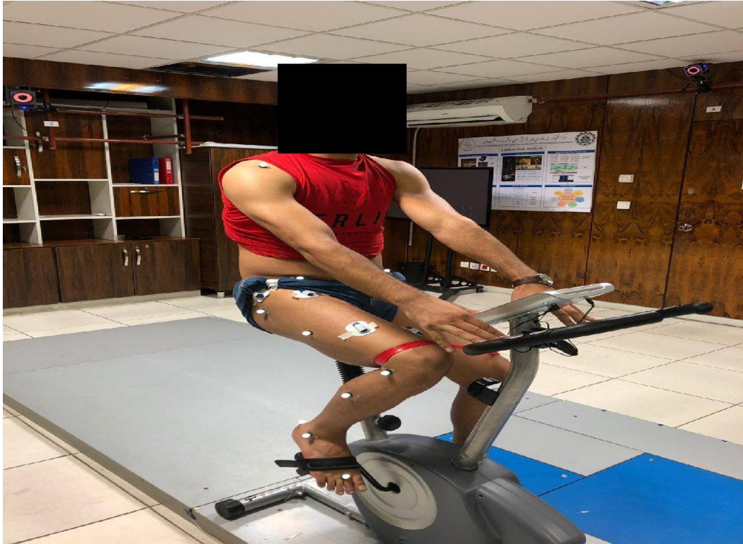
شکل ۱- آزمودنی در حال انجام رکاب زدن در دو شرایط متفاوت: با و بدون باند لوپ در انتهای فمور
