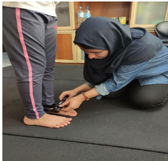
شکل ۱- نحوه اندازه‌گیری زانوی ضربدری با کولیس
