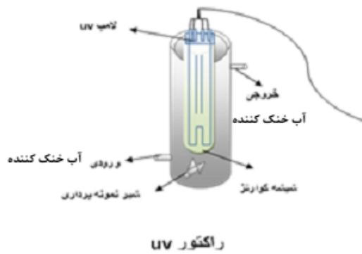
شکل ۱- شماتیک رآکتور UV ناپیوسته و مشخصات آن
