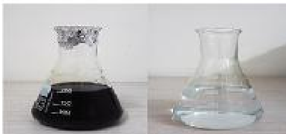
شکل ۲- سنتز نانوذرات نقره (سمت راست، محلول نیترات نقره و سمت چپ، پس از افزودن عصاره گیاهی)
